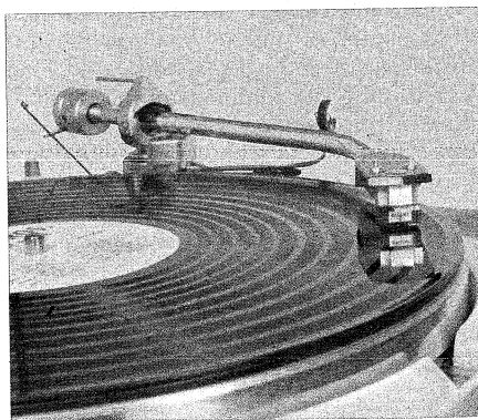
Bild 4. Skatingkraft-Detektor im Shure-SME-Tonarm bei unkompenzierter Skatingkraft
